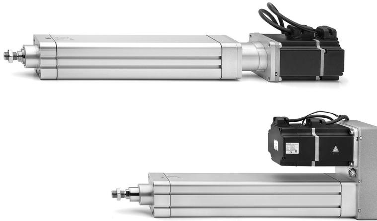
Les vérins Série 6E sont des actionneurs mécaniques linéaires avec tige, à l'intérieur desquels, le mouvement rotatif généré par un moteur est converti en mouvement linéaire au moyen d'une vis à recirculation de billes. Disponibles en 6 tailles, la Série 6E a des dimensions basées sur le standard ISO 15552 et c'est par ceci qu'il est possible d'utiliser les accessoires de fixation des vérins pneumatiques
