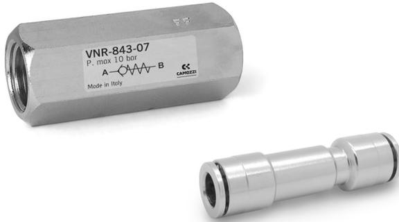
Les clapets anti-retour Série VNR autorisent le passage d'un flux dans un seul sens même à basse pression. La conception à clapet permet un fonctionnement à basse pression et ce, aussi bien en phase de passage de l'air qu'en phase de retenue.
