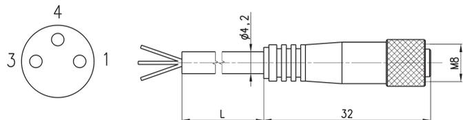
En cas de branchement avec capteur 2 fils avec connecteur mâle M8 ( Mod. CST-250N, CSV-250N, CSH-253 ), connecter le fils marron de la rallonge au + de l'alimentation et le noir à la charge.
