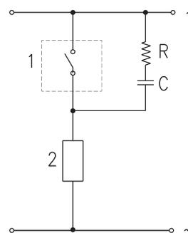
Application en courant continu/alternatif : Les capteurs Reed n'étant pas protégés contre les surtensions dues aux charges inductives, ajouter une protection contre les surtensions. Voir exemples ci dessus. Légende :
