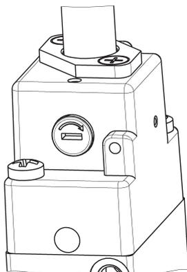
Exemple pour un électro-distributeur avec une commande bistable standard par tournevis.
