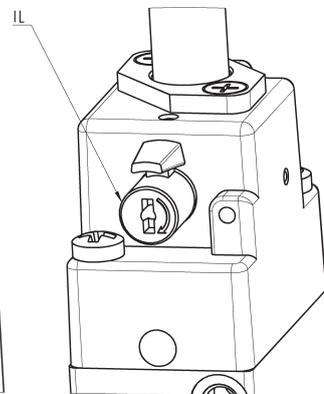
Ex. d'un distributeur monostable ( IM ) et d'un distributeur bistable avec cde par tournevis et manuelle ( IL ).
