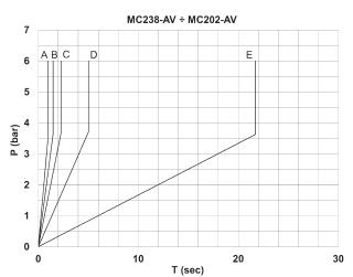
Temps de démarrage selon le nombre de tours de vis de réglage avec un volume de 5 litres. MC104-AV
