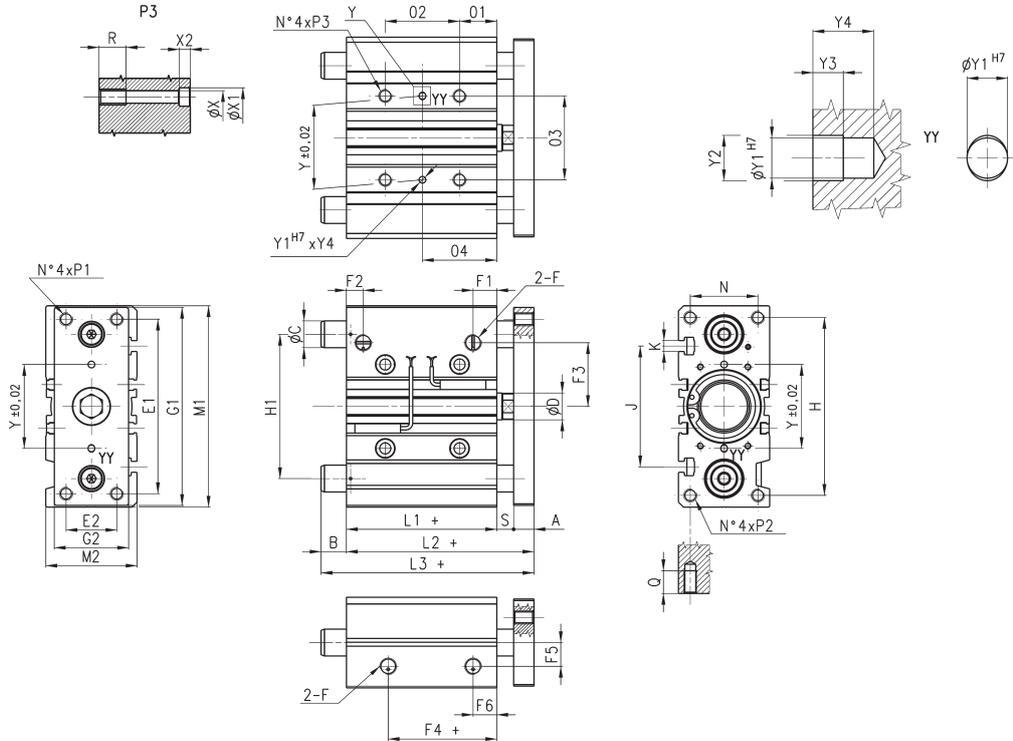
Lors de l'utilisation des orifices latéraux d'alimentation, dévisser les bouchons correspondants et les revisser sur les orifices des alimentations frontales jusqu'à ce qu'ils soient affleurants et sans aller en fond de filet du corps; Tout en utilisant un produit d'étanchéité.
