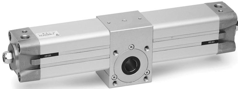
L'ensemble pignon/crémaillère a été réalisé en acier cémenté. De plus, le pignon est monté sur deux roulements à billes. Enfin, une vis permet un réglage de l'angle de rotation de  $\pm 5^\circ$ .
