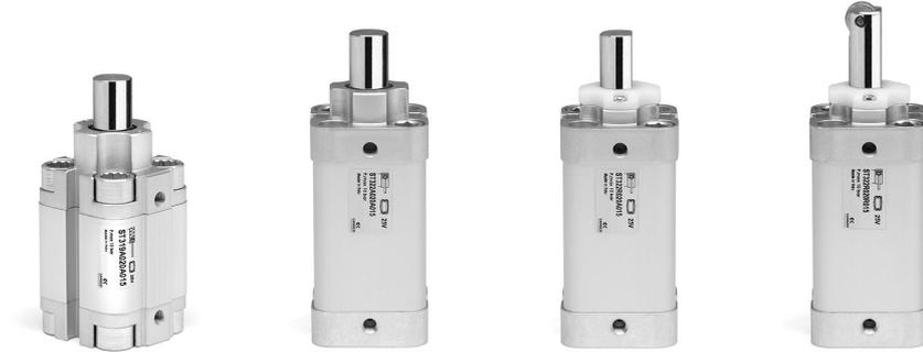
Les vérins Stoppeurs Série ST sont des actionneurs pneumatiques, conformes aux normes UNITOP et ISO 21287, pour lesquels la tige et la bague de guidage ont été spécialement surdimensionnées pour garantir une résistance élevée aux chocs et charges radiales. Ces vérins existent en version simple effet, double effet et ressort arrière. Il existe aussi une version avec tige anti-rotation.
