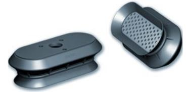
Pour répondre aux applications de préhension d'aliments souples et fragiles comme le fromage à pâte molle, COVAL a développé une ventouse oblongue 1,5 soufflets en Silicone compatible alimentaire et pouvant être équipée d'une grille inox permettant d'éviter la déformation de l'aliment.
