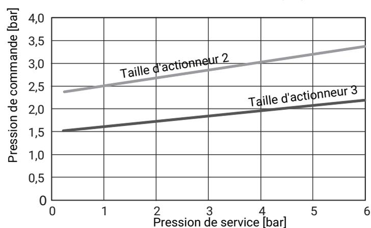
Raccord d'air de pilotage : G 1/8
