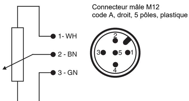
Cette version convient au raccordement au positionneur GEMÜ 1434, 1436 ou 1435 en version avec connecteur mâle M12.
