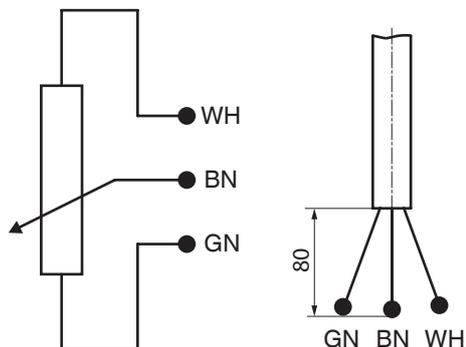
Cette version convient au raccordement au positionneur GEMÜ 1435 (sauf GEMÜ 1435 en version avec connecteur mâle M12).
