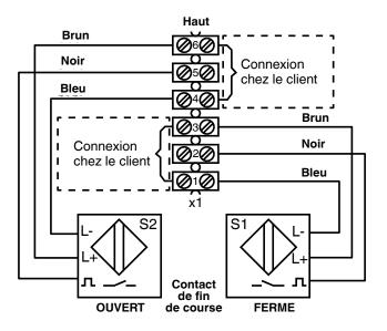
Plan de câblage connecteur M12 (code 309)
