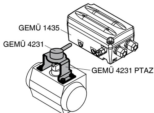
Le montage déporté et l'utilisation de composants supplémentaires différents permettent d'utiliser la vanne (à condition que cela soit autorisé) même dans les zones explosives. Pour ce faire, le positionneur doit être installé en dehors des zones explosives et la liaison avec le capteur de déplacement doit se faire via des barrières de sécurité.
