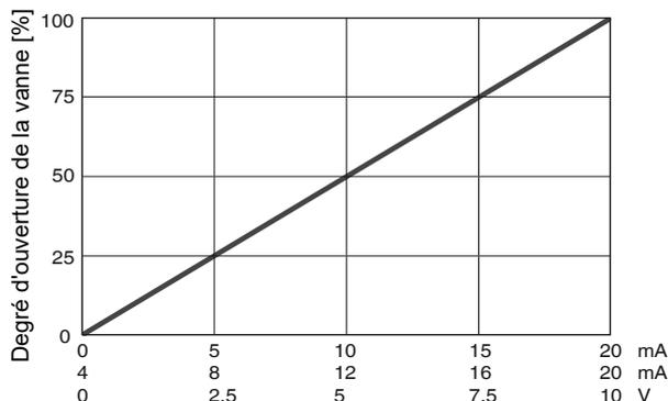
Le positionneur 1435 ePos détecte automatiquement la fonction de commande de la vanne pendant l'initialisation, et s'ajuste en standard pour que la vanne soit fermée avec l'entrée de signal 0/4 mA et 0 V.\*
