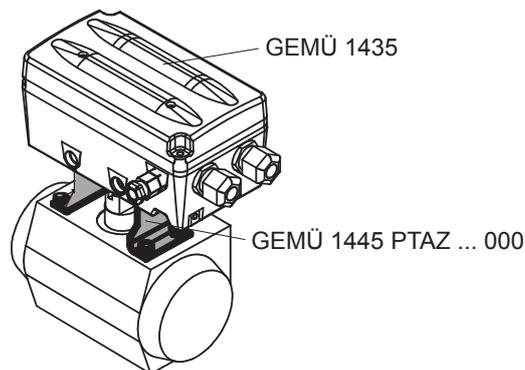
Pour le montage direct (via l'adaptateur NAMUR) du positionneur sur les raccords d'air de pilotage alignés horizontalement ou verticalement d'un actionneur quart de tour, vous avez besoin des composants suivants
