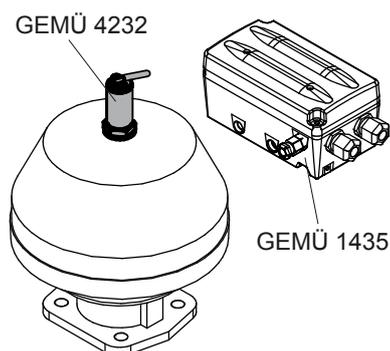
Le montage déporté et l'utilisation de composants supplémentaires différents permettent d'utiliser la vanne (à condition que cela soit autorisé), même dans les zones explosives. Pour ce faire, le positionneur doit être installé en dehors des zones explosives et la liaison avec le capteur de déplacement doit se faire via des barrières de sécurité.
