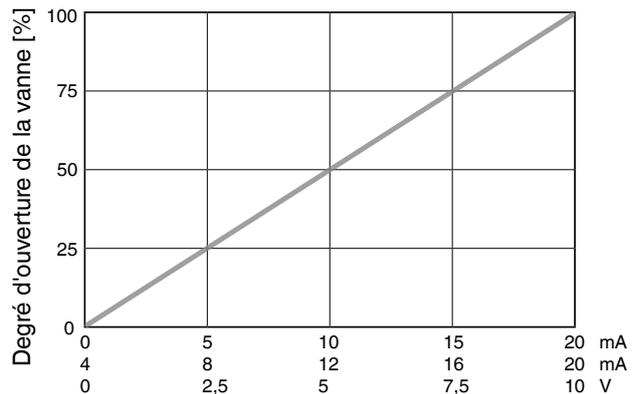
Lors de l'initialisation le positionneur GEMÜ 1436 cPos® eco détecte automatiquement la fonction de commande de la vanne: Normalement ouverte (NO) ou Normalement fermée (NF). En présence d'un signal égal à 4 mA la vanne est fermée.
