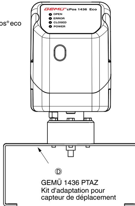
**Ⓐ Données pour la commande - Positionneur GEMÜ 1436 pour montage direct**
