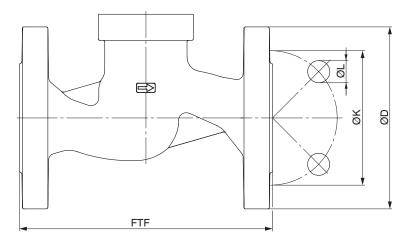
Type de raccordement bride, encombrement EN 558 (code 8) 1), fonte sphéroïdale (code 90) 2)
