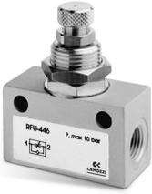
Pour régler la vitesse, le volume d'air contenu de la chambre à l'échappement doit être réglé. Le limiteur doit être connecté comme suit : relier l'orifice 1 à l'entrée du vérin; relier l'orifice 2 à la sortie du distributeur.
