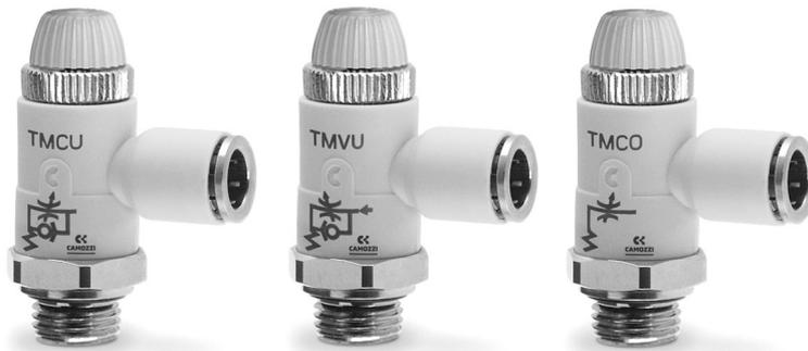
Les limiteurs de débit unidirectionnels et bidirectionnels Séries TMCU, TMVU et TMCO ont été conçus de manière à être le plus compact possible tout en garantissant un débit élevé. Un contre-écrou permet le tarage du réglage effectué. Ils sont destinés à réguler la vitesse de vérins simple ou double effet.
