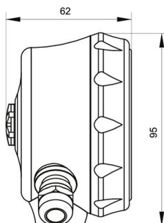
FlexHousing avec raccord process en bas
