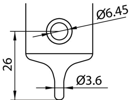
Embout du capteur avec élément de capteur
