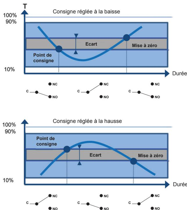
Un élément sensible à "tension de vapeur" actionne un microrupteur par l'intermédiaire d'un piston. Le réglage de la consigne est obtenu par un ressort comprimable monté en opposition.
