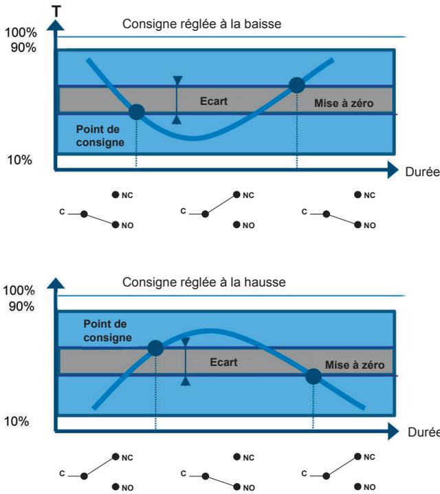
Un élément sensible à "tension de vapeur" actionne un microrupteur par l'intermédiaire d'un levier. Le réglage de la consigne est obtenu par un ressort comprimable monté en opposition.
