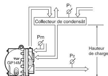
Le débit est déterminé par le fluide moteur, la pression du fluide moteur ( $P_m$ ) et la contre-pression ( $P_2$ ).
