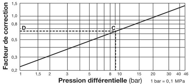
La pression différentielle est la différence entre les pressions à l'entrée et à la sortie du purgeur.
