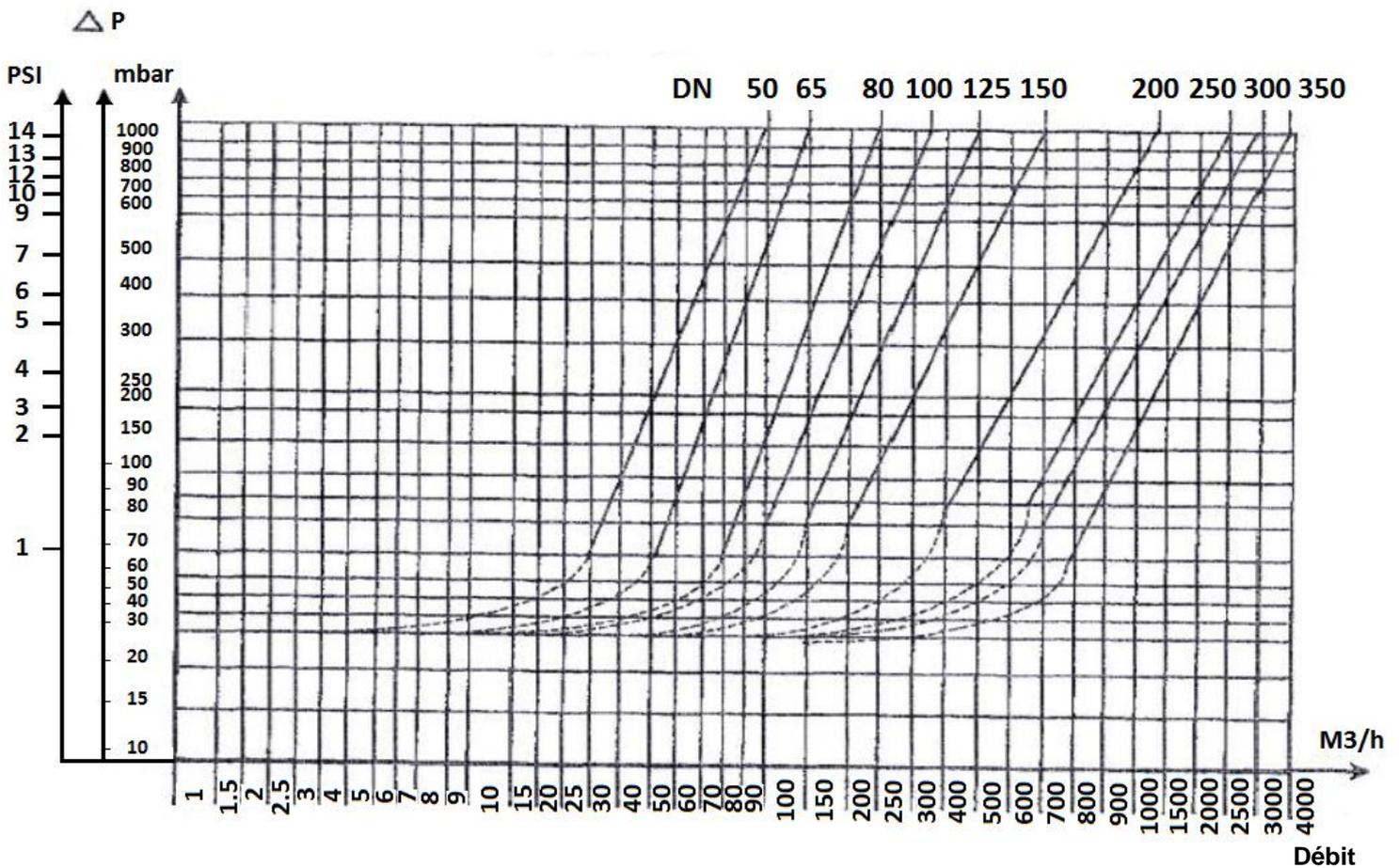
**CLAPET DE NON RETOUR SIMPLE GUIDAGE A OGIVE FONTE-INOX-EPDM PN16**
