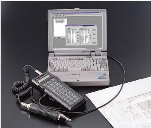
**TrapManager** vous permet de déterminer à l'avance la route à suivre pour une inspection. Celle-ci peut alors simplement être téléchargée vers le **TM5**. Lorsque l'inspection d'un purgeur est terminée, le numéro du prochain purgeur à inspecter apparaît sur l'écran du **TM5**.
