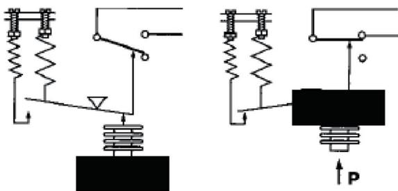
Un élément sensible déformable actionne un microrupteur par l'intermédiaire d'un levier. Le réglage de la consigne est obtenu par un ressort comprimable monté en opposition.
