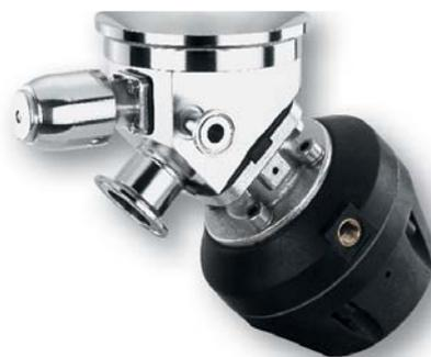
Les vannes de cuve sont aujourd'hui disponibles dans un grand nombre de modèles. Elles sont montées ou soudées sur le couvercle, la paroi ou le fond d'une cuve. Les fonctions principales sont le remplissage, la prise d'échantillons et la vidange. Quelquefois il y a une combinaison de ces fonctions dans une vanne pour des raisons de sécurité de process, dans certains cas il y a même des fonctions ajoutées, par exemple des raccords CIP/SIP intégrés.
