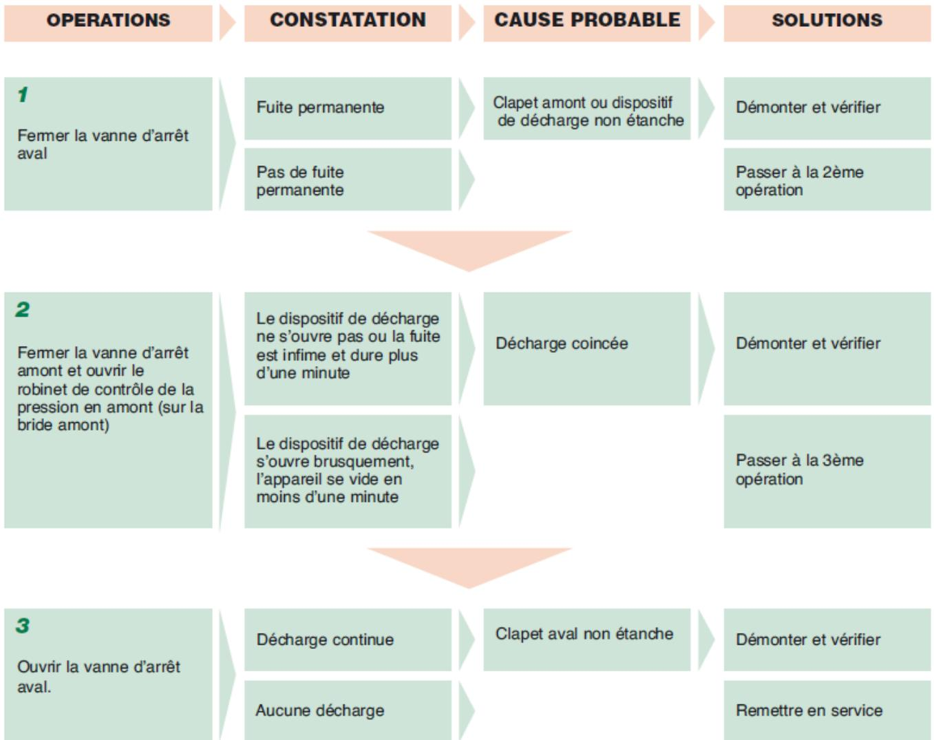
N.B. : Pendant le service normal l'appareil ne doit présenter aucune fuite permanente. En cas contraire, démonter et vérifier.
