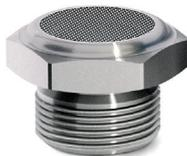
Les silencieux sont des éléments indispensables pour éliminer ou réduire le bruit caractéristique de l'air comprimé lors du rejet dans l'atmosphère. Ils doivent toujours être placés sur les sorties des vannes 3/2, 5/2 ou 5/3. Lors de l'entretien, les silencieux doivent être dégraissés avec du white spirit ou de la paraffine et traversés par de l'air comprimé dans le sens inverse de celui du fonctionnement.
